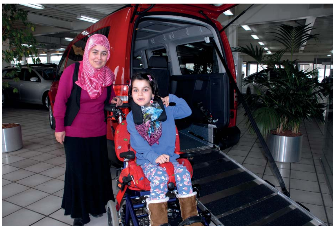
Der VW Caddy Maxi Life ist behindertengerecht umgebaut: Baran kann über eine Rampe im Rollstuhl sitzend in den Wagen hineingefahren werden. Und vorn ist noch reichlich Platz für die Eltern und Barans großen Bruder.
